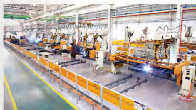
开元前车架智能化柔性焊接生产线
